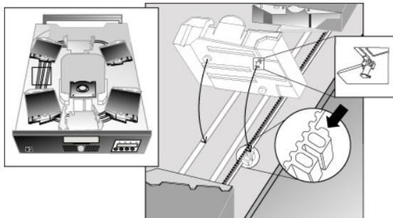
13. Inserte la clavija en la parte inferior del cargador de cartucho en la ranura de la correa y, a continuación, gire el cargador hasta asegurarlo en la correa.
