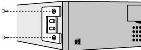
5. Si el cargador automático tiene soportes de instalación (unidad montada en bastidor), retire los cinco tornillos en la parte posterior del cargador automático y los dos tornillos adicionales en cada panel lateral para soltar la cubierta del cargador automático. Para una unidad externa, retire los tornillos de la cubierta frontal y los tres tornillos adicionales en cada panel lateral de la unidad.
